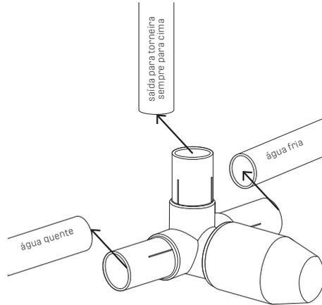
**3-** Depois de finalizado o acabamento da parede (pintura, revestimento, etc.), retire a proteção da capa e encaixe o acabamento da parede.
