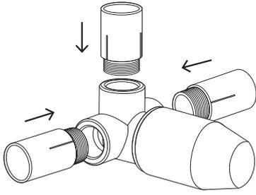
**2-** Faça a ligação com a tubulação na parede, seguindo o esquema abaixo.
