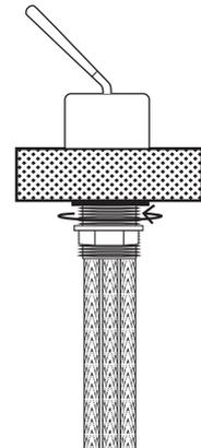
**4- Fixe as mangueiras de água quente, fria e saída para torneira, na parede utilizando níséis.**
