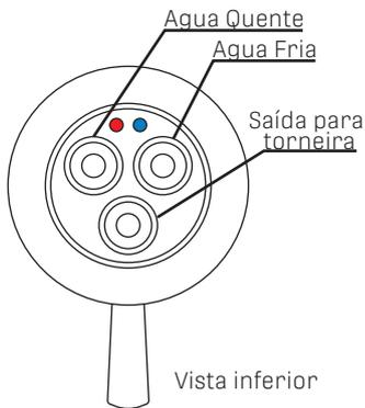
**2- Instale as mangueiras no monocomando, seguindo a ordem abaixo: Passe pela porca, arruela do comando e borracha de vedação, em seguida passe pela bancada e pela segunda borracha de vedação.**
