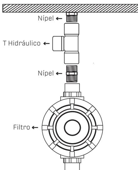
**5- Utilizando os nípeis metálicos, fixe a mangueira de água quente na saída de água quente da parede e a mangueira de água fria no T Hidráulico.**
