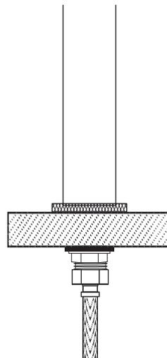
**3-** Fixe a mangueira flexível na saída de água na parede utilizando um nípel.
