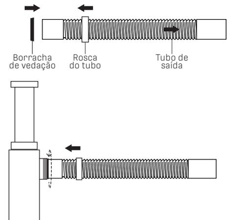
**4-** Passe o acabamento pelo tubo de saída e o encaixe no ponto de esgoto. Caso a saída seja padrão DN40, utilize o adaptador para vedar a saída.
