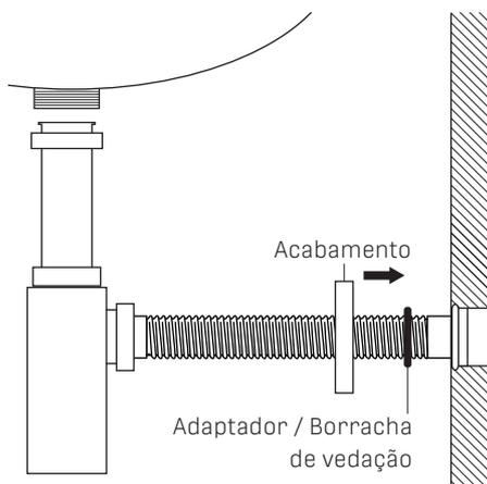
**5-** Na sequência encaixe a borracha de vedação na rosca de 1 1/4" e então rosqueie na válvula de escoamento apertando até fixá-la firmemente.
