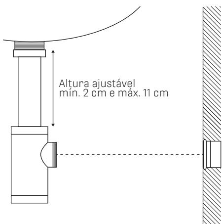
**2-** Meça a distância entre a saída do sifão e o ponto de esgoto, considerando o embutimento necessário. Corte o tubo de saída, se necessário.
