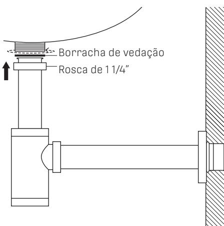
**6-** Para limpeza interna do copo, desrosqueie a rosca de 1 1/4" da válvula e a rosca do tubo de saída e em seguida puxe o tubo de entrada. Faça a limpeza e recoloque-os novamente.
