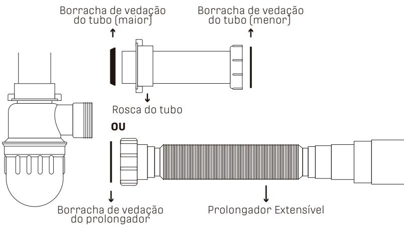
Caso opte pelo prolongador extensível, verifique o diâmetro da medida interna da entrada do esgoto e, caso necessário, corte a extremidade escalonada de modo a obter o diâmetro da entrada.
