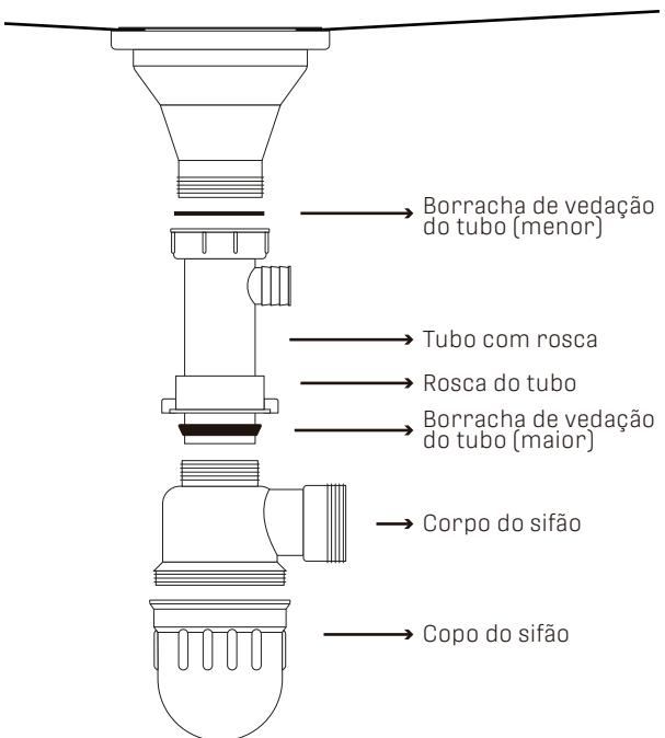
**3- Para a instalação na entrada de esgoto, utilize o segundo tubo com rosca ou então o prolongador extensível.**
