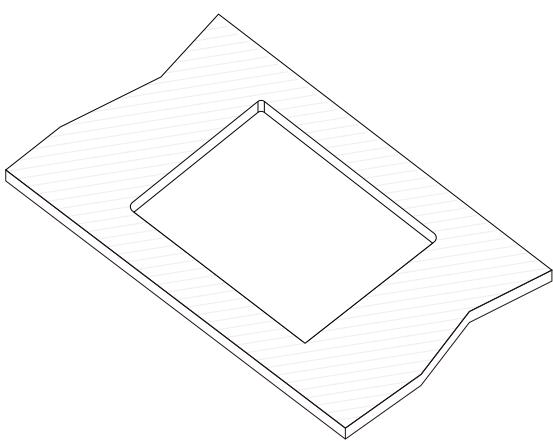
**4- Posicione a cuba alinhada ao recorte e marque a posição dos 4 furos para instalação das buchas. O centro dos furos deve estar a 9mm da borda da cuba (ou seja, a 35mm do recorte).**
