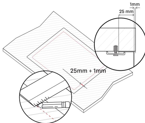
**4-** Posicione a cuba alinhada ao recorte e marque a posição dos 4 furos para instalação das buchas. O centro dos furos deve estar a 9mm da borda da cuba (ou seja, a 35mm do recorte).
