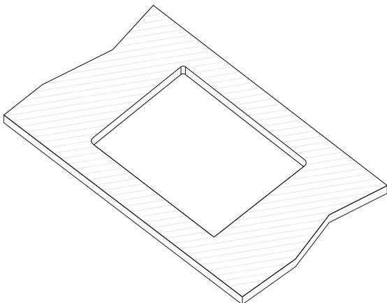
**2-** Desconte 26mm (equivalente a borda + 1mm) e faça uma nova marcação.
