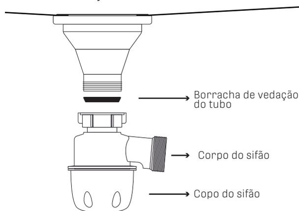
**3- Para a instalação na entrada de esgoto, rosqueie o sifão flexível ao corpo do sifão, utilizando uma borracha de vedação, em seguida encaixe o adaptador de saída de esgoto do sifão e conecte no ponto de esgoto.**
